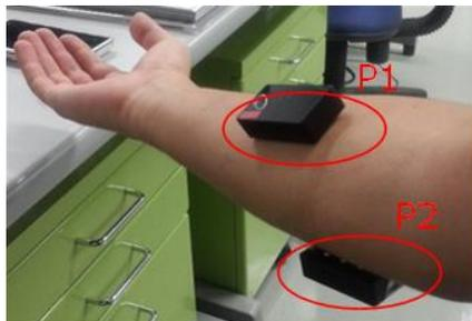
図 3 筋電位センサを固定する腕の位置
