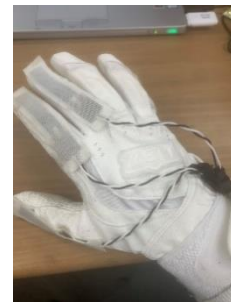
図 1. stretch sensor を野球のグローブに貼った要素の写真
