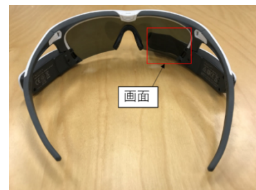
図 1. 実装に用いたスマートグラスとその画面
